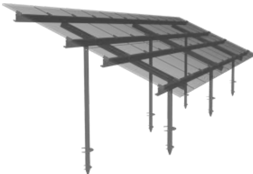
Fig. 5.4. Detaliu de structură de susținere panouri cu micropiloți forajați
